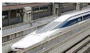
【Mc5】:H14製作 ・先頭部長さ:23m ※試験的に最大限伸ばした形状
