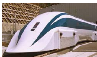
【Mc1】:H7製作 ・先頭部長さ:9.1m ※第一編成車両
