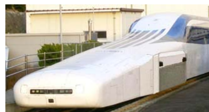
【Mc5先頭形状改良タイプ】 ・先頭部長さ:15m(H21改造)
