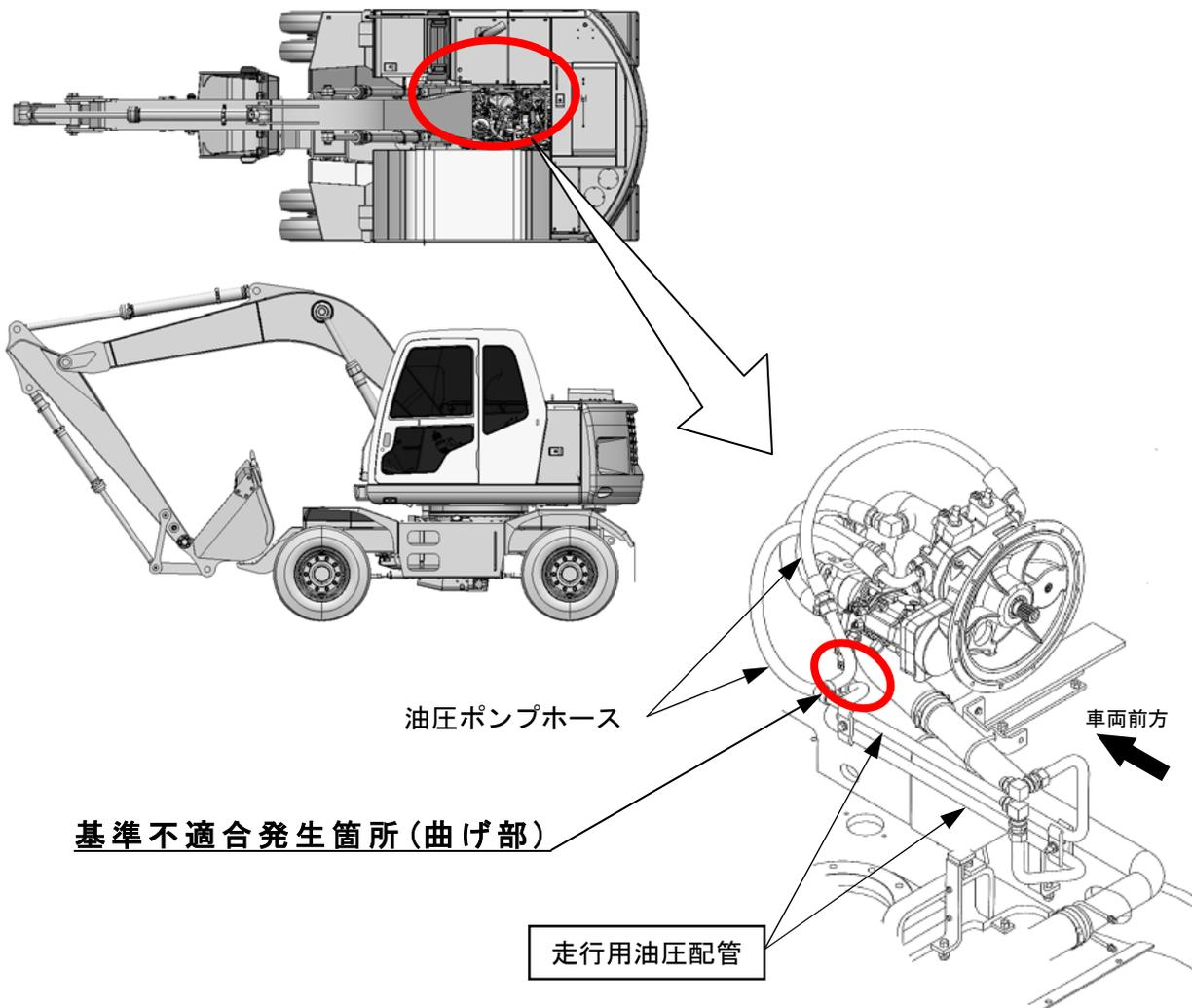
走行用油圧配管において、配管の曲げ加工が不適切なため、走行時の油圧により当該配管に亀裂が発生する場合があります。そのため、そのままの状態で使用を続けると、作動油が漏れ、最悪の場合、走行不能になるおそれがある。
