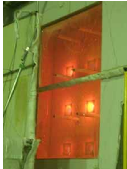
ガラス面(高さ2.4m×幅1.8m)の試験体を耐火炉で片側から全面的に加熱
