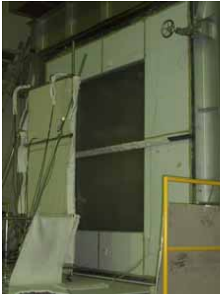
ガラス面(高さ2.4m×幅1.8m)の試験体を耐火炉で片側から全面的に加熱
