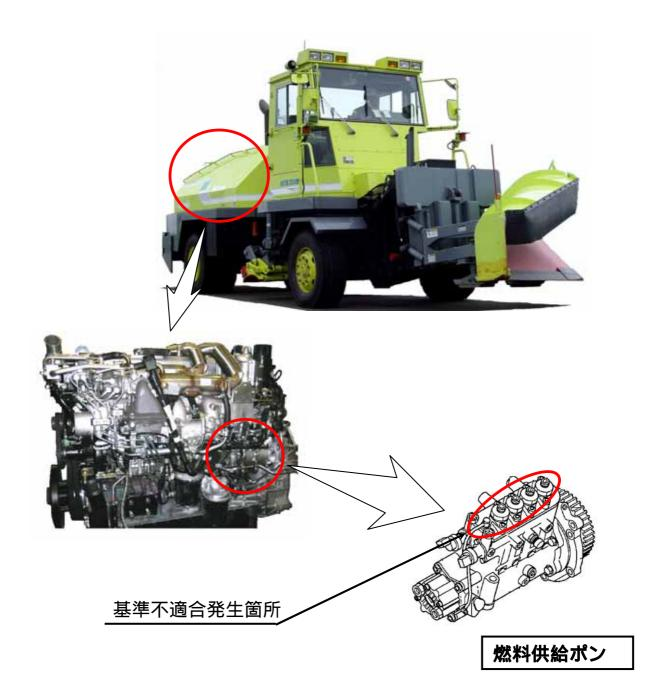
燃料噴射装置において、燃料供給ポンプの製造時の加工が不適切なため、当該ポンプの内部に亀裂が発生し、燃料が漏れ、エンジンオイルに混入するものがある。 そのため、そのままの状態で使用を続けると、燃料の混入したオイルがブローバイガスの通路を経由して吸気管に吸入されシリンダー内で燃焼するため、エンジン回転の上昇、エンジン停止及び再始動不能となり、最悪の場合、燃料の混入したエンジンオイルが漏れ火災に至るおそれがある。
