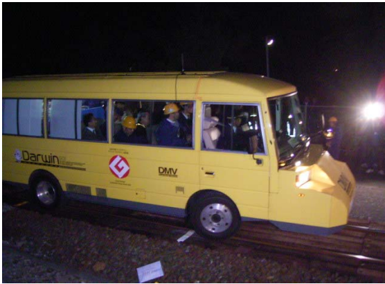
写真左：線路走行から道路走行への切替地点 写真右：道路走行
