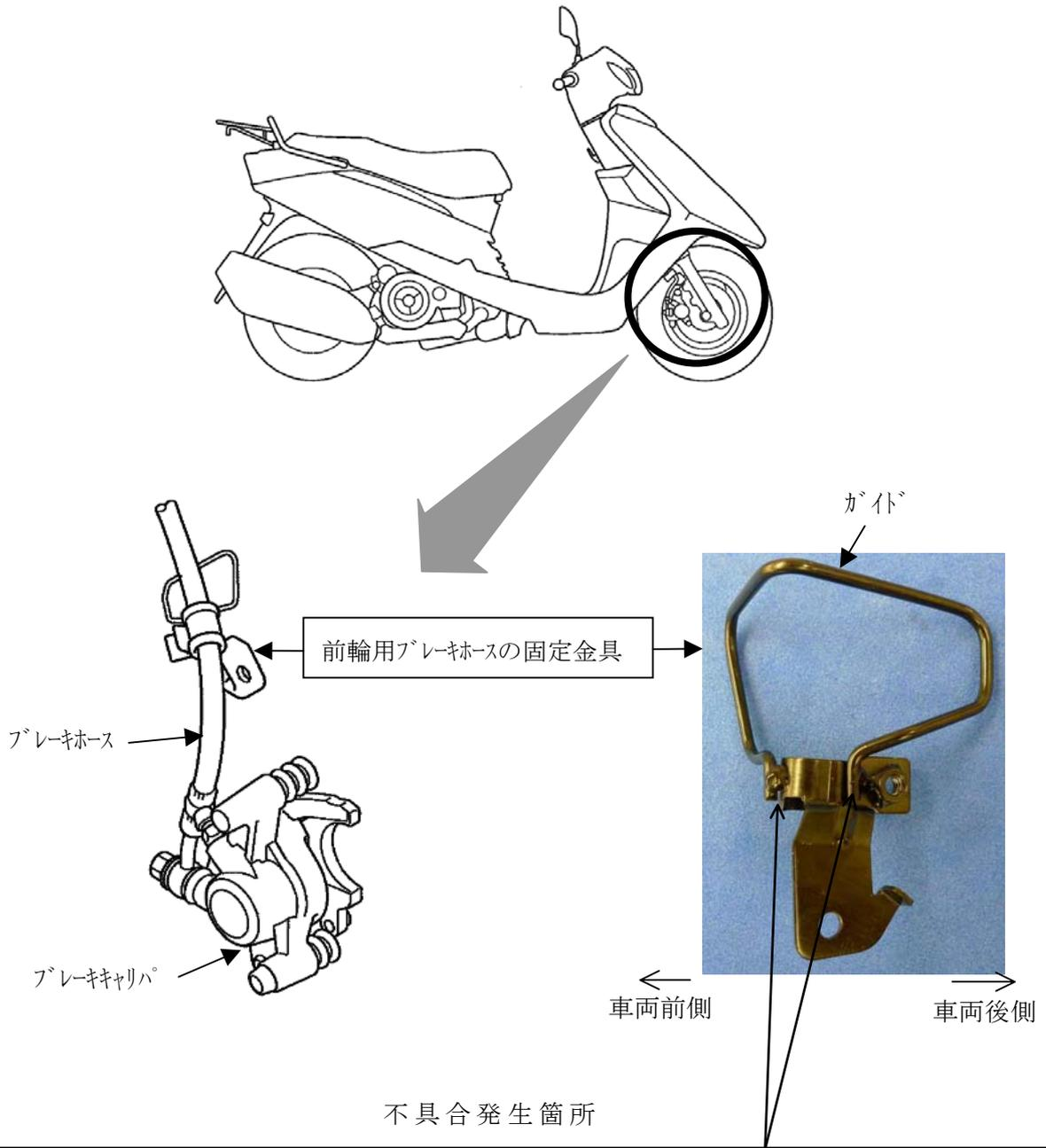
前輪用ブレーキホースの固定金具において、ガイド取付部の溶接が不適切なものがある。そのため、走行中の振動等により当該取付部に亀裂が発生し、そのまま使用を続けると、走行中にガイドが脱落して、他の交通の妨げとなるおそれがある。
