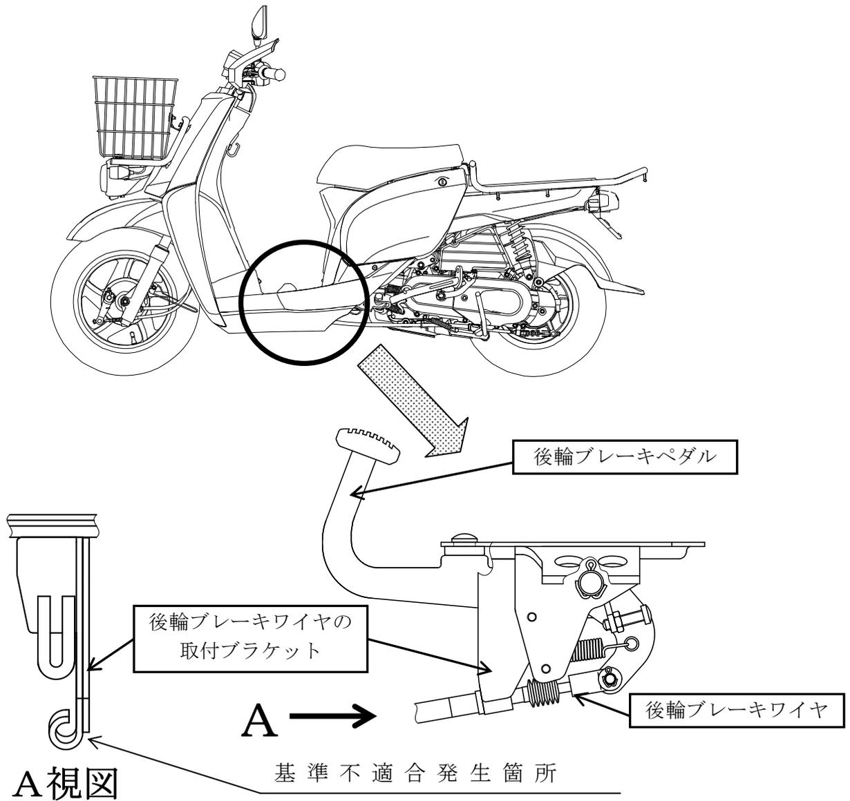
後輪ブレーキワイヤの取付ブラケットの溶接が不適切なため、足踏み式後輪ブレーキを過大な力で踏み込むと当該ブラケットが変形することがある。そのため、そのまま使用を続けると、インナーワイヤがアウターワイヤ端部と擦れて折損し、最悪の場合、後輪ブレーキが効かなくなるおそれがある。
