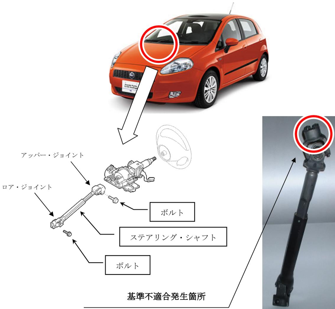
ステアリング・シャフトにおいて、アッパー・ジョイント・ボルトの組み付け工程が不適切なため、ボルトの締め付け力が不足、または過剰のものがある。そのため、ハンドルのすえ切りを繰り返すと、当該ジョイントに亀裂が入り、最悪の場合、ジョイントが折損し、ハンドル操作ができなくなるおそれがある。
