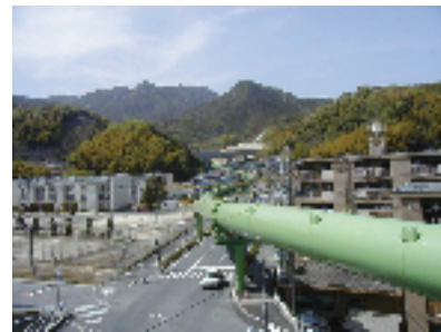
図 5-16 新しい土砂運搬方法の事例 25)
