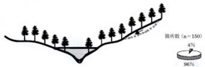
図 2.1 - 2 立木の流出による流木の発生状況（福井豪雨の事例）
