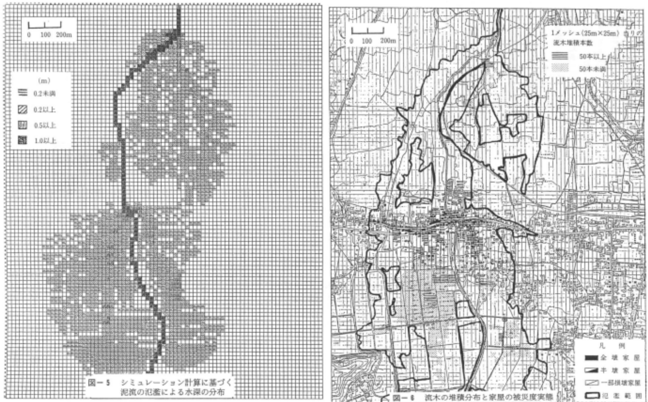
図 2.1 - 18 平成2年7月の集中豪雨時の熊本県一の宮市におけるシミュレーションに基づく泥流の氾濫による水深分布及び実際の流木堆積分布
