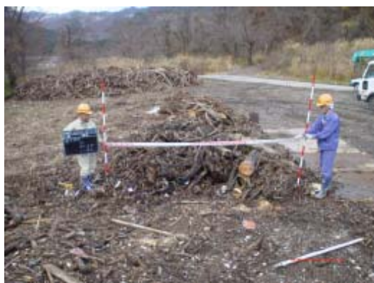
写真-2 分類した流木の計測実施例（積み上げて形状計測）
