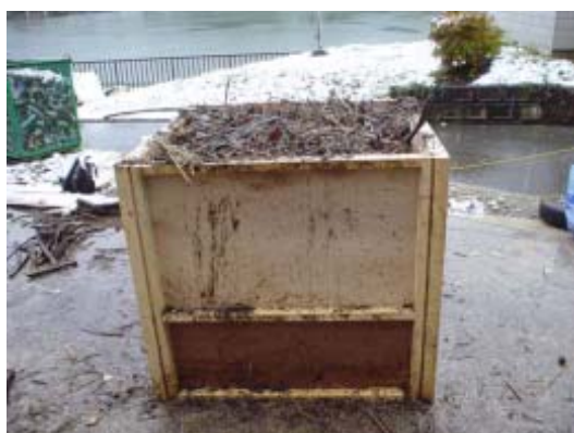
写真-3 分類した流木の計測実施例（定型の箱を使用）
