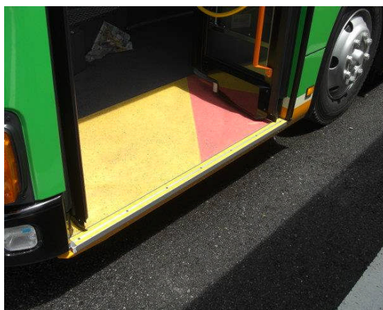
図7 扉可動域の床面の赤表示の例
