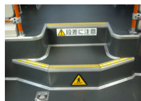
図3 後部立席拡大車両の段差 ステップ高さ：220mm+225mm
