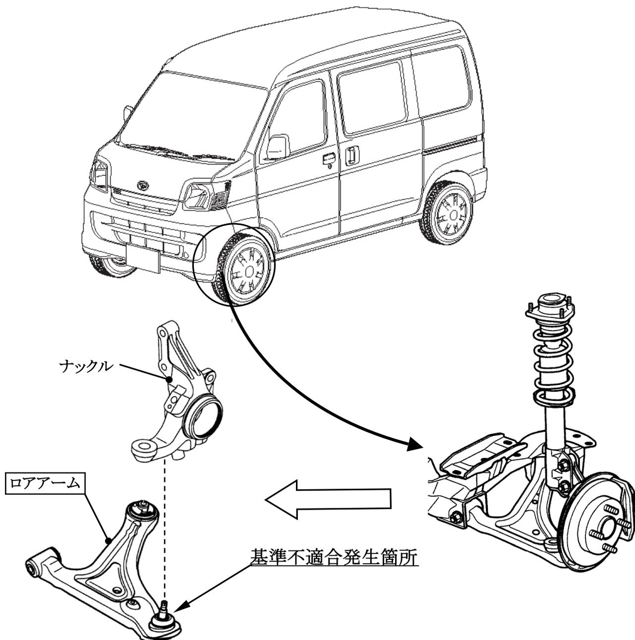
前輪緩衝装置のロアアームにおいて、ナックル連結部のかしめが不足しているものがある。そのため、縁石等に衝突した場合、ロアアームからナックル連結部が外れて走行不能になるおそれがある。
