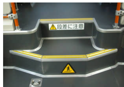
図2.4 後部立席拡大車両の段差 (ステップ高さ：220mm+225mm)
