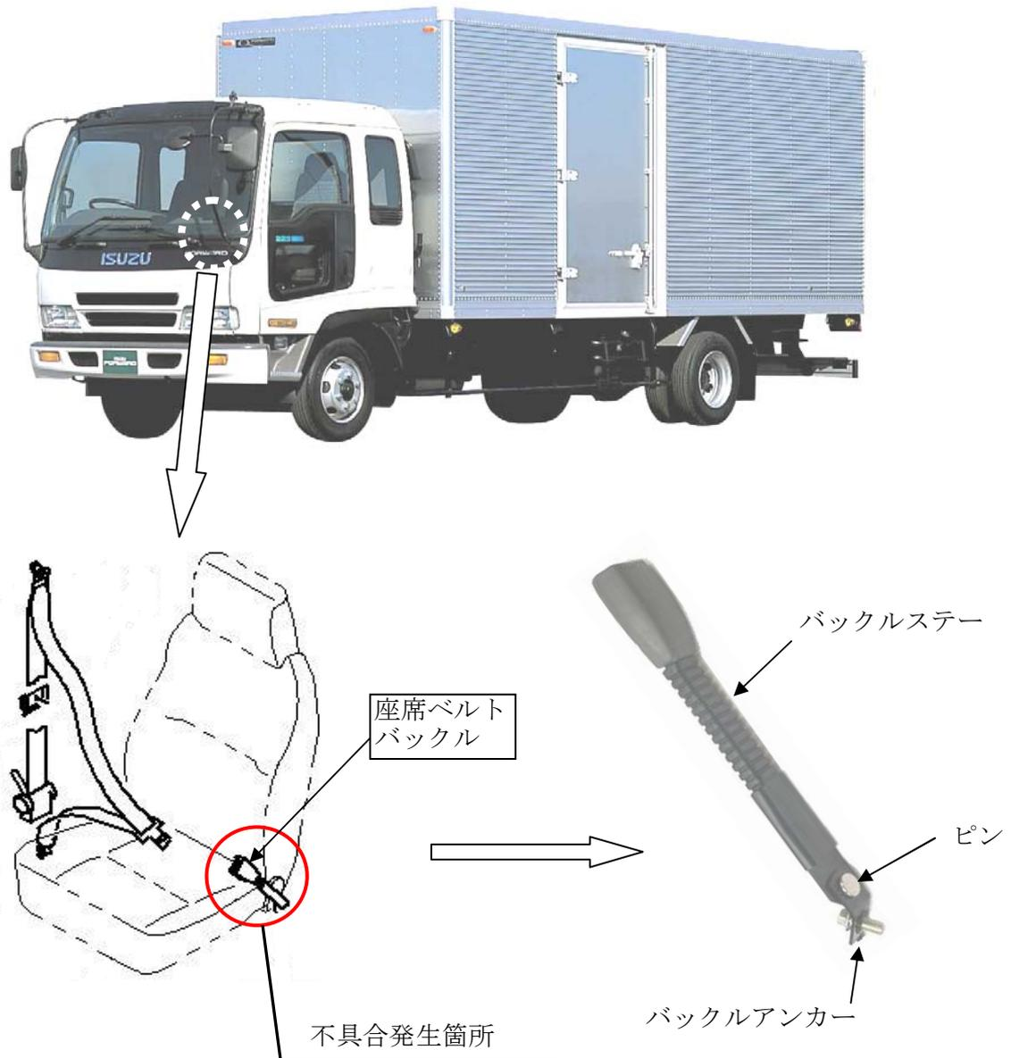
交換修理用として販売した運転席用の座席ベルトバックルにおいて、バックルステーとバックルアンカーを固定しているピンに不適切な材料を使用したため、当該部品に亀裂が発生しているものがある。そのため、そのまま使用を続けると、当該バックルが外れるおそれがある。
