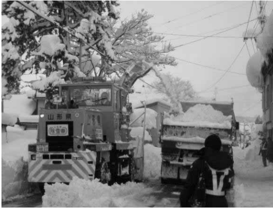
ダンプトラックへの積み込み作業
