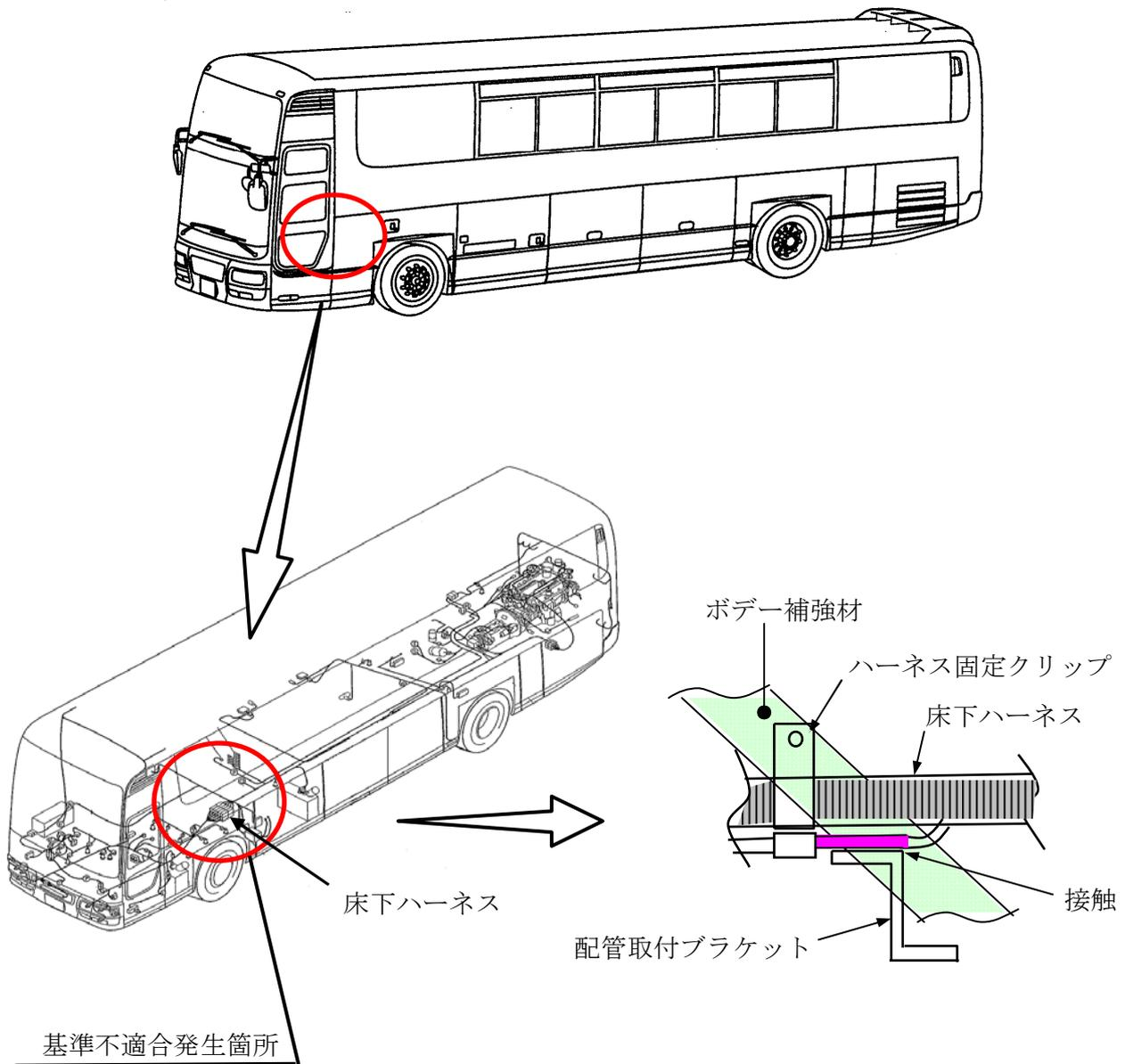
大型バスにおいて、床下ハーネスの配索が不適切なため、ハーネスが配管取付ブラケットと接触しているものがある。そのため、そのままの状態で使用を続けると、車両振動等により被覆が損傷し、最悪の場合、エンジントール及び灯火器等が不灯に至るおそれがある。
