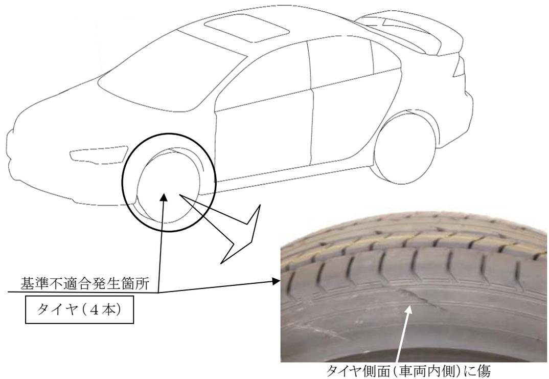
タイヤとホイールの組付け工程の設備故障により、タイヤの側面に傷が付いているものがある。そのため、そのままの状態で使用を続けると最悪の場合、当該傷が徐々に進行し、空気圧が低下するおそれがある。
