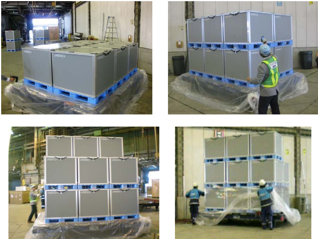
図 3-21 小型コンテナのみのビルドアップ作業
