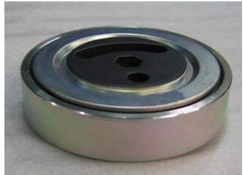
パワーステアリングポンプ駆動用ベルトの張力を調整するテンショナプーリの外周樹脂部の材質が不適切なため、当該樹脂部が破損することがある。そのため、異音が発生し、最悪の場合、当該ベルトがパワーステアリングポンププーリより外れてハンドルの操作力が増大するおそれがある。
