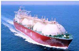
天然ガスをマイナス162度の超低温で液化したLNG(液化天然ガス)を運ぶ船舶。超低温輸送のための特殊な材質のタンクなど、先端技術を駆使したハイテク船。船価が高いため、特定の天然ガス輸入プロジェクトの専用船として建造されることが多い。
