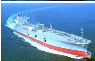
プロパンやブタンなどを液化したLPG(液化石油ガス)を運ぶ船舶。防熱材はタンクの内側にあり、その表面をメンブレンというステンレスの薄膜で被って油密を保つ。輸送中に気化したガスを液化する装置も備えている。
