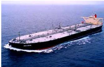
原油を運ぶ専用船。複数の区画に仕切られたタンク状の船倉を持ち、事故時の原油流出を最小限に抑えるため船側と船底を二重構造化している。荷役用のパイプラインとポンプを持つ。一時50万重量トンを超える大型の船も出現したが、現在は20~30万重量トン級のものが最大級。
