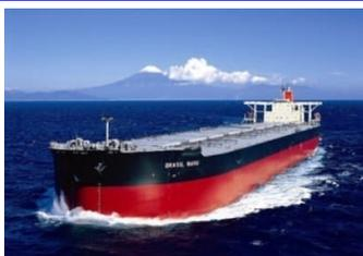
鉄鉱石や石炭、穀物などのバラ積み貨物を運ぶ船舶。小型のものは本船自体に荷役用クレーンを備えている。大型のものは陸上に設けられたアンローダーという荷役機械(バキューム式、機械式)で荷役を行う。
