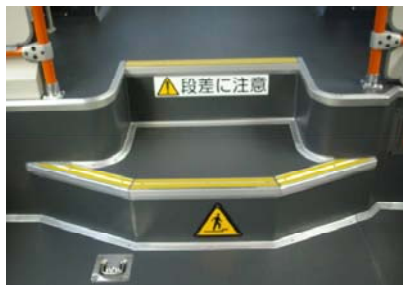
中間段差の例
