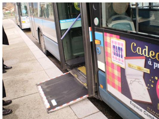
写真 10: 運転席からの操作により乗降板が出てくる設計 (バス) (SMTIC 資料)
