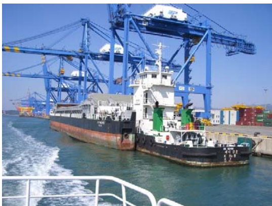
写真 3 BPA公共フィーダバージ船 プッ シャ方式(最大153TEU 但し、上甲板乗せをし
