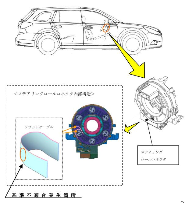
ステアリングロールコネクタのフラットケーブルにおいて、製造時に当該ケーブルに塗布しているグリスの製造ばらつきにより、当該ケーブルの表面にケミカルストレスクラックが発生するものがある。そのため、そのまま使用を続けると当該クラックを起点に導線が断線し、運転席エアバッグの不作動、警音器の不鳴となるおそれがある。
