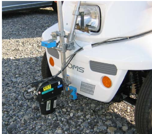
図 10 非接触速度計の取付け状況
