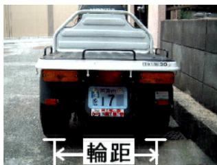
輪距・・・左右のタイヤの接地面の中心と中心との距離、トレッド幅
