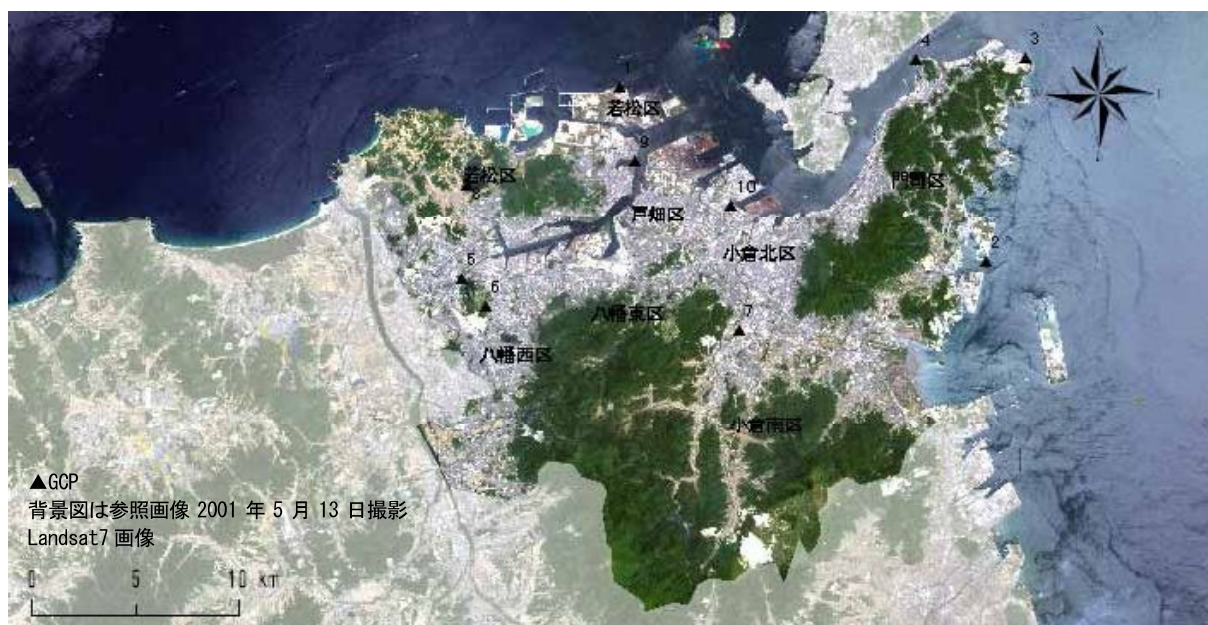
図 2.3 2006 年 6 月 16 日撮影 ASTER 画像幾何補正に関わる GCP 位置図
