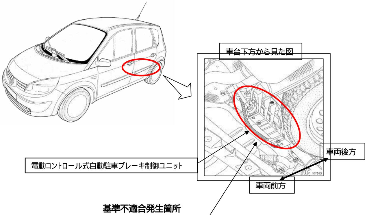
電動コントロール式自動駐車ブレーキ制御ユニットのプログラムが不適切なため、電気配線等の接触不良により ABS コントロールユニット及びインジェクションコントロールユニットの電源供給が途絶えた場合、車両が停車したと誤認識し、走行中に駐車ブレーキが掛かるおそれがある。
