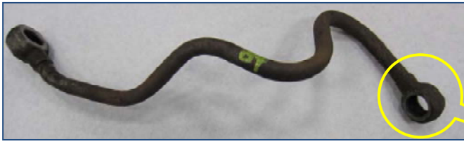
写真 35 潤滑用オイルパイプ (入口)
