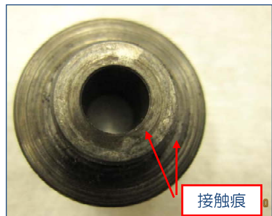
写真 29 スラストスリーブ コンプレッサーホイール側
