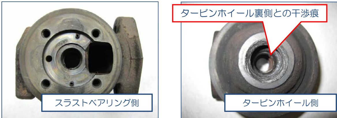
写真 42 ベアリングハウジング
