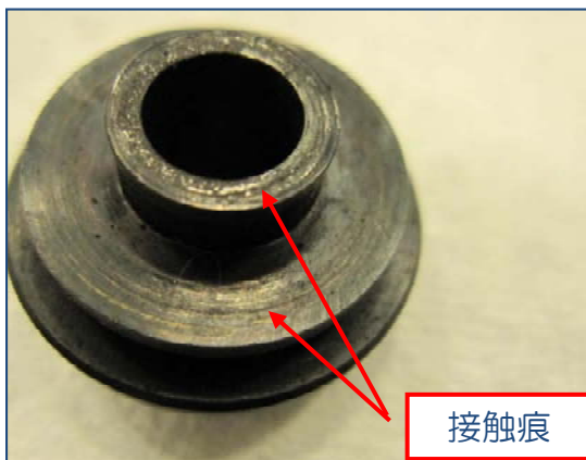
写真 28 スラストスリーブ スラストベアリング側
