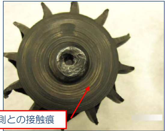
写真 31 タービンホイール裏側
