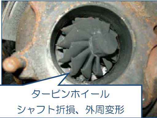
写真9 右ターボチャージャー タービン側
