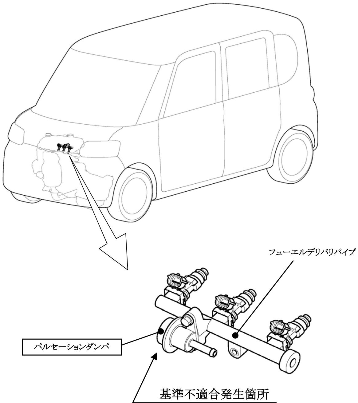
〔 エンジンの燃料装置において、パルセーションダンパ(燃料圧脈動減衰器)の製造工程でダイヤフラムを傷付けたものがある。そのため、そのままの状態で使用を続けると、車両の使用過程における燃料圧の脈動で当該ダイヤフラムの傷から亀裂が生じ、燃料が漏れるおそれがある。 〕
