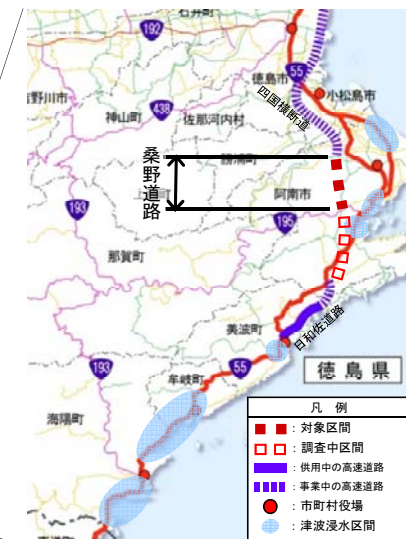
図4 国道55号浸水箇所想定図
