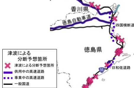
図2 津波浸水による分断箇所
