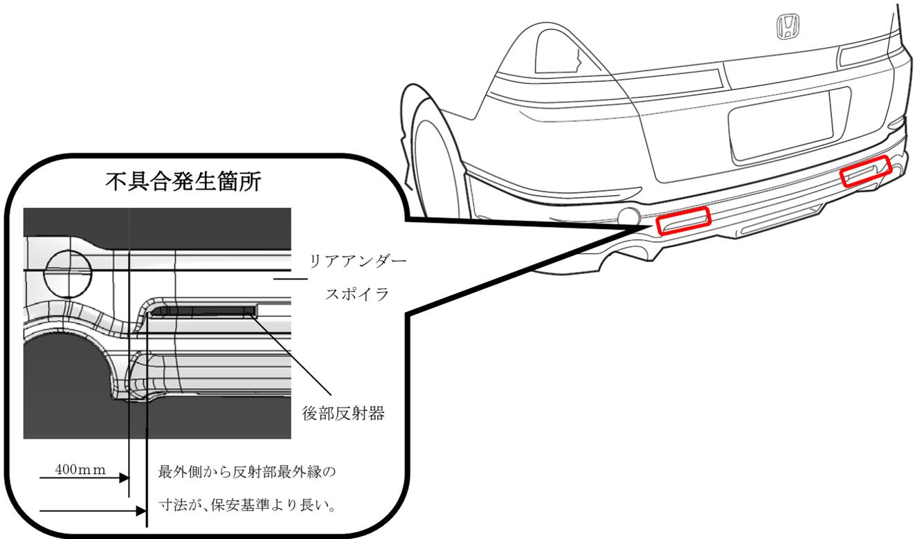
後付け部品として販売したリアアンダースポイラを車両に取り付けた場合、後部反射器の一部が覆われて反射部の最外縁と車両の最外側との寸法が400mmより長くなり、保安基準に適合していない。
