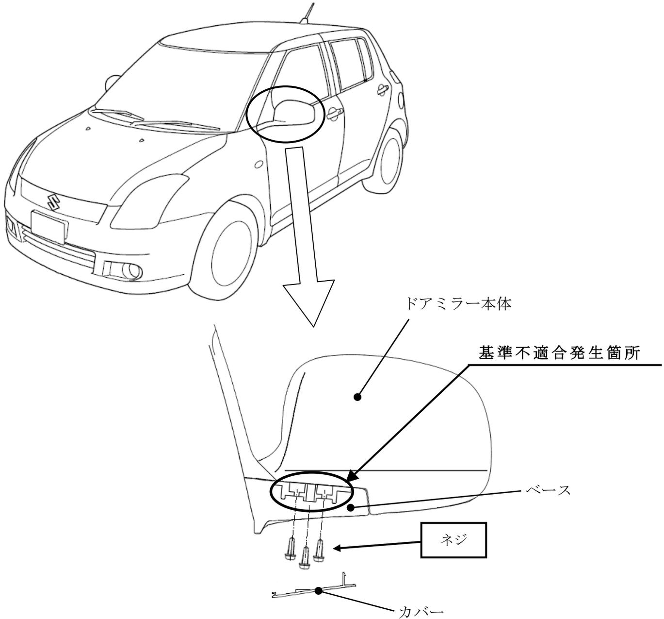
ドアミラーにおいて、ドアミラー本体とベースを締結するネジに緩み止めが無い場合、使用過程における振動や強めの外力によるへたりに当該ネジが緩み、そのままの状態で使用を続けると、最悪の場合、ドアミラー本体がベースから外れ、後方の交通状況等が確認できなくなるおそれがある。
