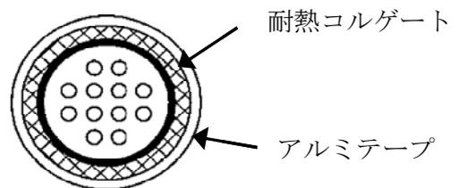
識別：エキゾーストパイプおよび電気配線の外観にて容易に識別が可能のため、特別な識別の追加は行わない。
