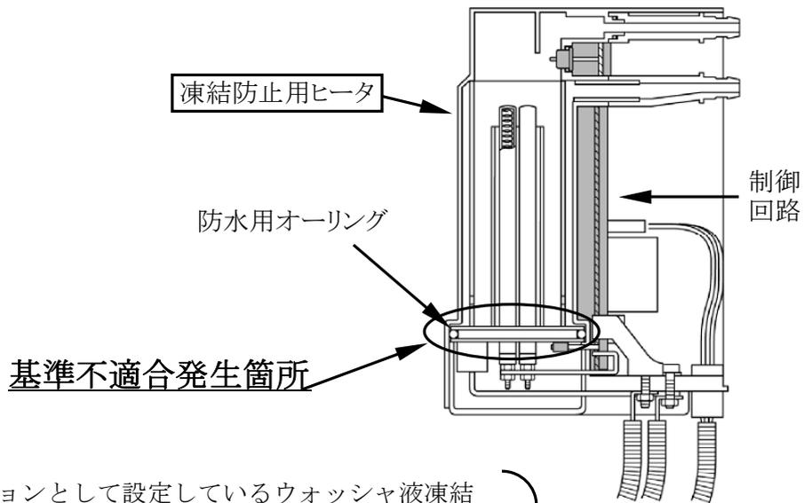
販売店オプションとして設定しているウォッシャー液凍結防止ヒータが装着された車両において、ヒータ制御回路部の防水用オーリングの締め代が不足しているため、ウォッシャー液が制御回路内に浸入することがある。そのため、制御回路が溶損し、最悪の場合、火災に至るおそれがある。
