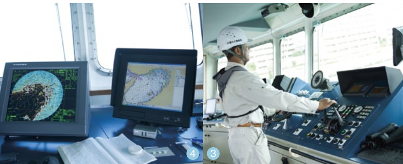
1. 神戸港に隣接している神戸港湾事務所 2. 瀬戸内を巡る Dr. 海洋。船にさまざまな装置を備え、ブリッジ部の両舷には船の状況を知らせる電光表示装置も 3. 午前 8 時半。船内でのクルーミーティングを終え、神戸港を出発。舵を取るのは神野 4. 操舵室には電子海図（写真右）や多機能レーダー（同左）など多くの航海計器が。カメラモニターにより海面や作業状況の監視、災害時の被災状況の伝達を効率よく行うことが出来る
