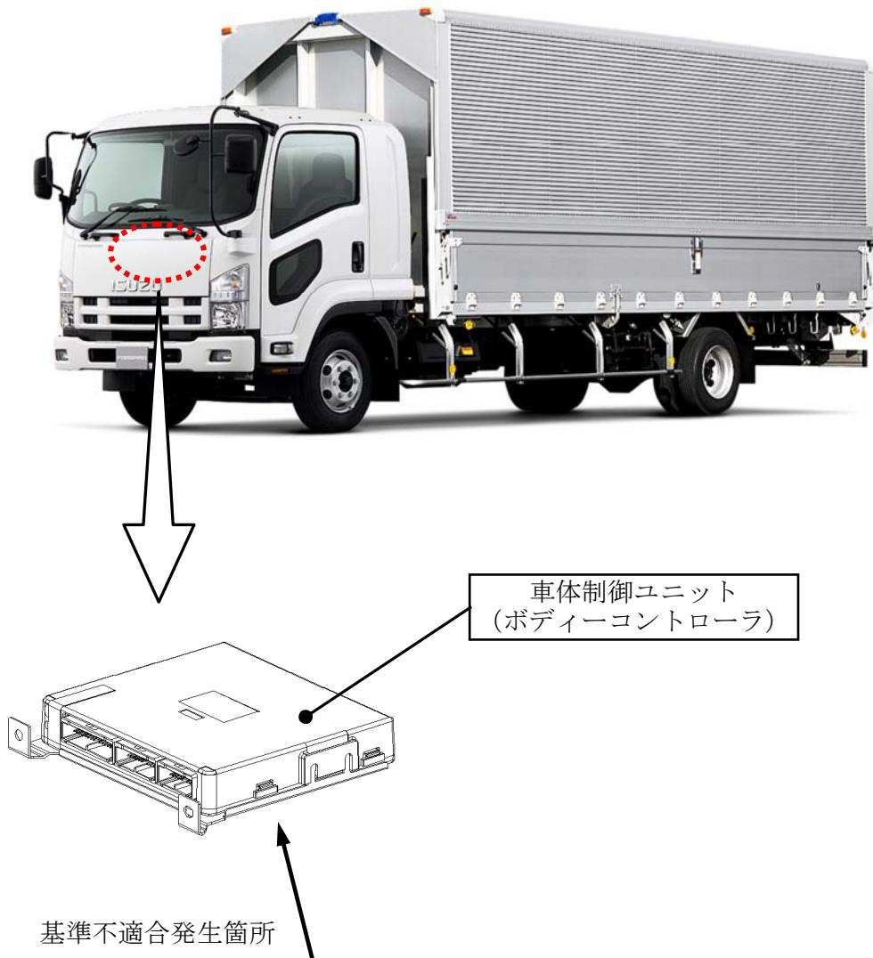
運行情報システムを搭載している車両において、車体制御ユニット（ボディーコントローラ）のプログラムが不適切なため、エンジンを停止した際に、運行情報システムの影響により、車体制御ユニットを書き換えてしまうことがある。そのため、当該ユニットが制御しているハザードランプ、エアコンファン等が誤作動するおそれがある。
