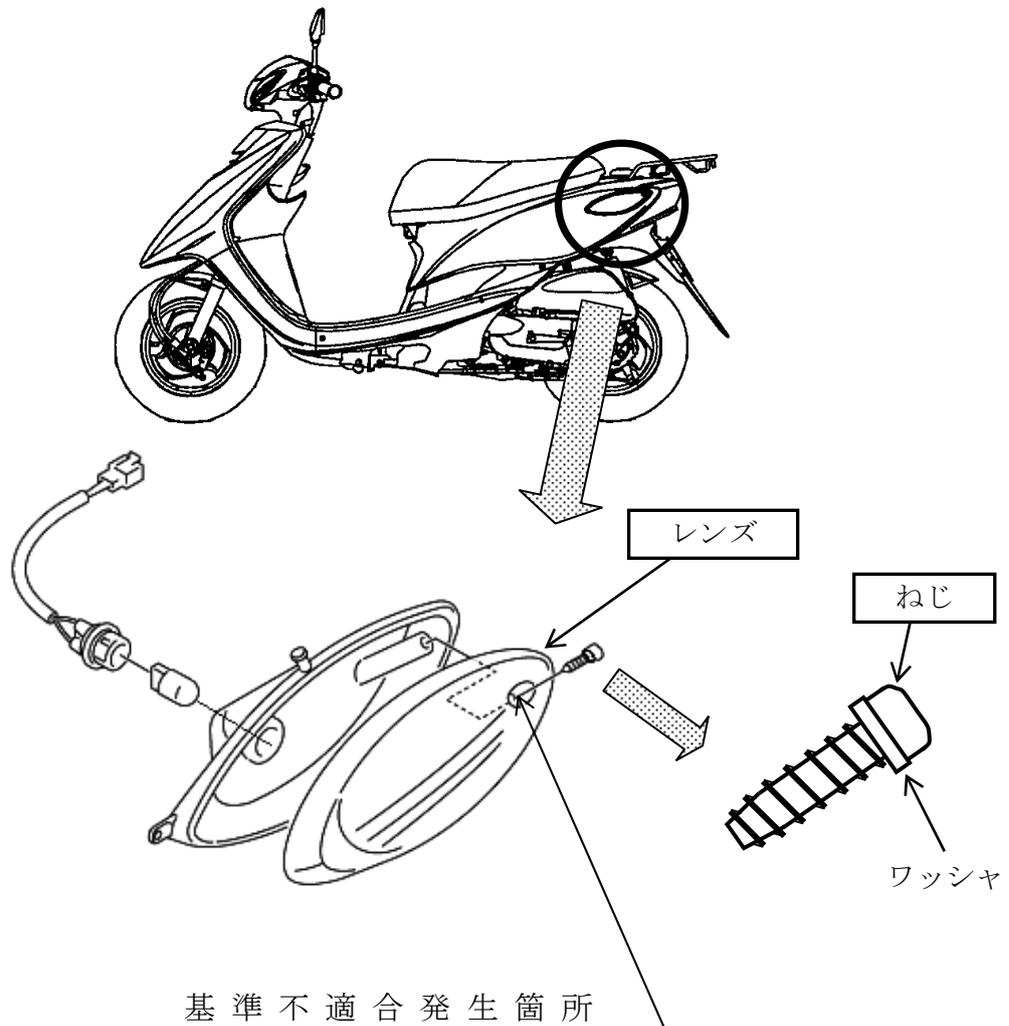
後面の方向指示器において、レンズを締め付けるねじの樹脂製ワッシャに含まれる成分により、レンズのねじ締め付部に亀裂が生じるものがある。そのため、そのまま使用を続けると、亀裂が進行し、最悪の場合、当該レンズが脱落するおそれがある。
