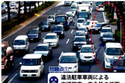
国道19号伏見通りは、地下鉄伏見駅を中心にオフィスや商業施設が集積し、車両・自転車・歩行者の通行量が多く、事故の発生や円滑な通行への支障など、車道側・歩道側の双方に問題が発生していた。そこで、片道5車線道路の再配分を行って、歩道側1車線の部分に貨物の荷捌き場、自転車道・駐輪場を設置しました。貨物の荷捌き場の設置により、無秩序な駐車を抑制する効果が期待されている。
