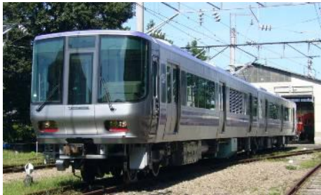
蓄電池を活用した鉄道車両
