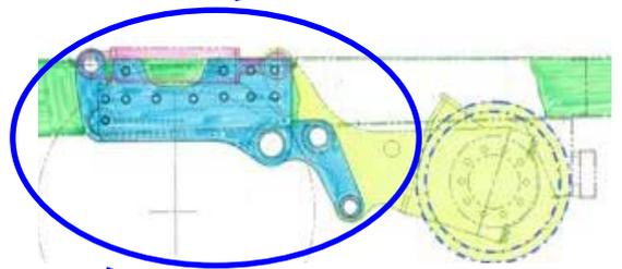
後軸用軌道走行装置取付けフレーム
