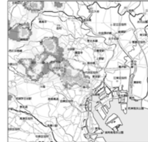
【XバンドMPレーダ】 (最小観測面積:250mメッシュ、観測間隔:1分 観測から配信に要する時間 1~2分)
