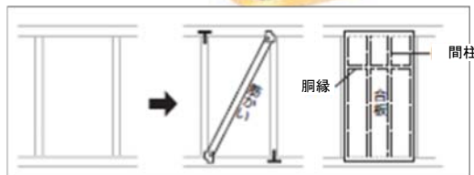
筋交い、合板による壁の補強
