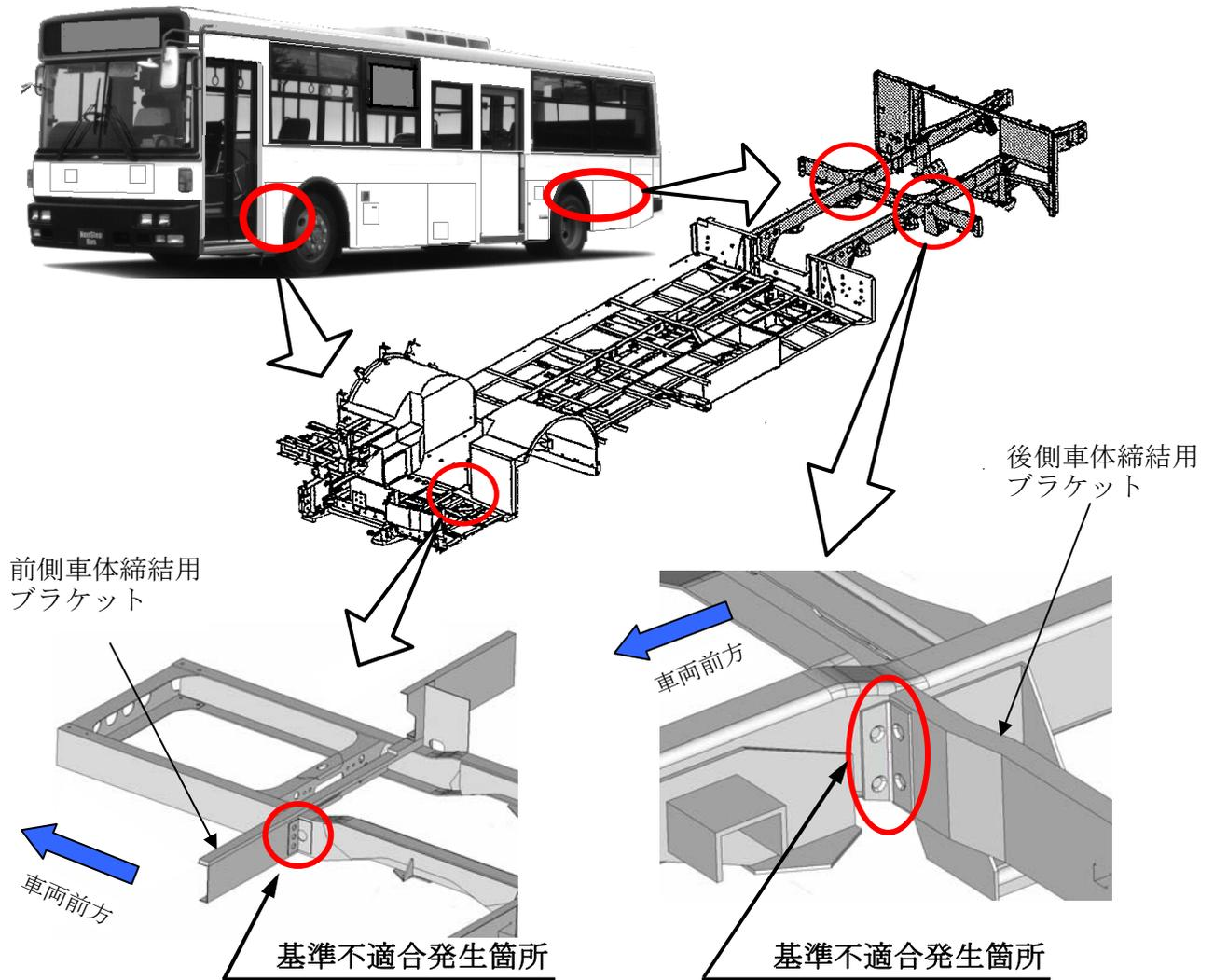
フレームと車体締結用ブラケットの結合材強度が不足しているため、亀裂が発生するものがある。そのため、そのままの状態で使用を続けると亀裂が進行し、最悪の場合、結合材が折損するおそれがある。
