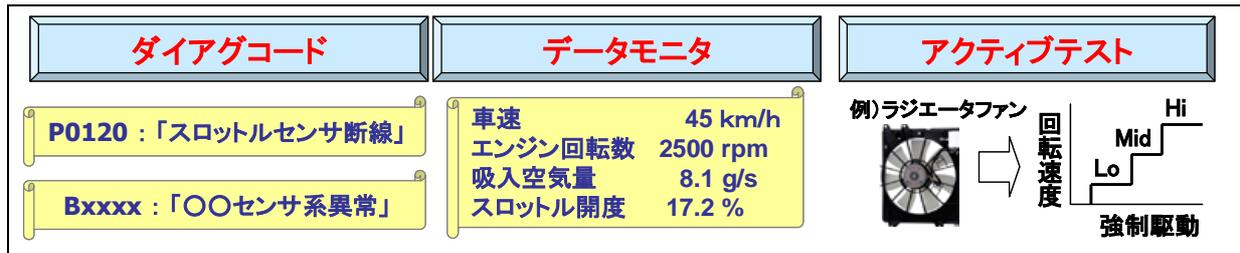
図 2 スキャンツールの機能例
