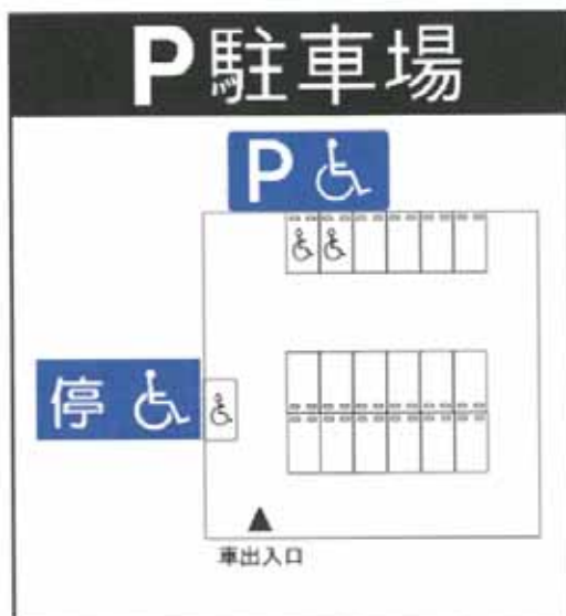
図6-6 駐車場の進入口において障害者用駐車施設の存在を案内している例
