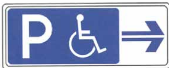
図6-7 障害者用駐車施設への誘導用標示板例
