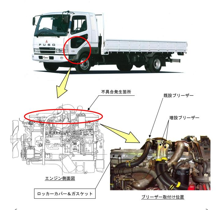
インジェクタの内部が粗悪燃料の使用等によって異常摩耗すると、燃料噴射量が増大し、ピストン に亀裂が発生して穴が開き、この穴開き部分から燃焼ガスがクランクケース内に漏れて内圧が 上昇する。そのため、ロッカーカバーからエンジンオイルが噴出し、最悪の場合、車両火災に 至るおそれがある。
