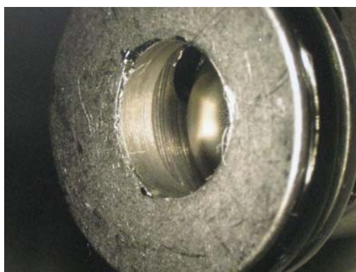
下降弁安定用チェック弁写真
