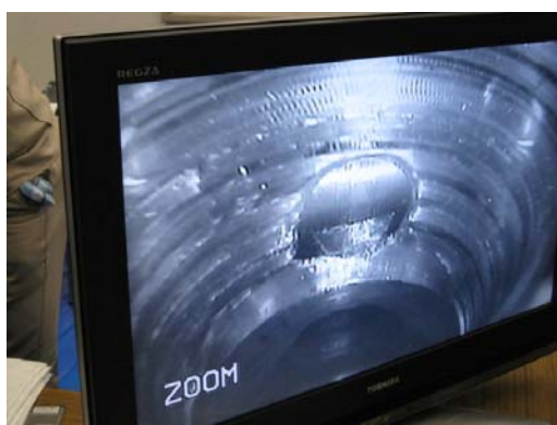
コントロールブロック部分のファイバースコープ画像 （中央の穴に金属がめくれているような箇所がみられる）
