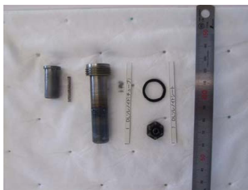
低速ソレノイド部品分解写真
