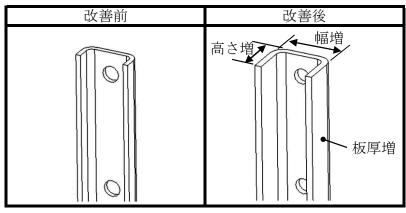
「大型トラックのブレーキ等のエアタンクにおいて、エアタンクブラケットの強度が不足しているため、車体振動等により当該ブラケットに亀裂が生じることがある。そのため、そのままの状態で使用を続けると、エアタンクブラケットが折損し、最悪の場合、エアタンクが脱落するおそれがある。
